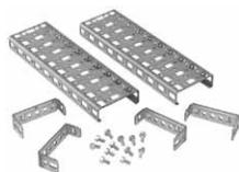
Las cintas de rejilla son de acero chapado calibre 14. Los orificios rectangulares de diseño especial permiten usar tuercas enjauladas o tuercas enjauladas de carga frontal. Los orificios de montaje se proveen con separación de 25 mm entre centros. Las cintas de rejilla están disponibles con una o tres filas de orificios y se entregan
