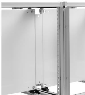
Provee una superficie de panel continua en gabinetes de varios compartimientos. El subpanel de unión se inserta entre subpaneles completos de igual altura. Puede instalarse por el frente o por atrás. Se proveen orificios para conexión a tierra y componentes para el montaje. El acabado es blanco. Los subpaneles de unión conductores son de acero galvanizado no pintado.
