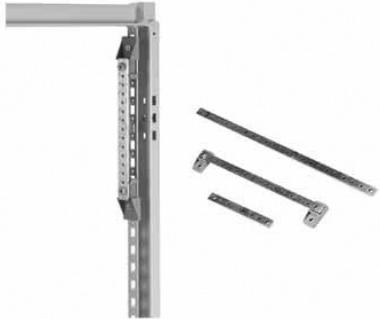
Hay tres tamaños disponibles de barras de conexión a tierra y soportes de montaje aislados. Las barras son de cobre chapado, con orificios roscados M6 y M5 para proveer un punto común de conexión a tierra del equipo. Compatible con todos los gabinetes si se montan en forma vertical. Vea la tabla para el montaje horizontal. Boletín: P20
