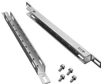
Las barras se montan en la barra de la puerta. Se usan para montar accesorios a la puerta. Hechas de acero calibre 16 con acabado chapado. Sostienen hasta 100 lb (45.4 kg).
